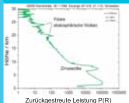
Lidarsignal Rückstreuungssignal eines Lidarsystems gemessen am 26.01.1998 in Esrange, Schweden
