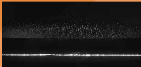
Plasmakristall im Praktikumsversuch. Die Teilchen schweben über der unteren Hochfrequenz-Elektrode. Bildbreite: ca. 3 cm.
