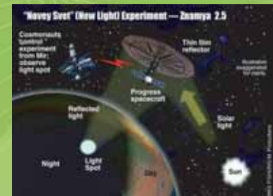
ZNAMYA: Experiment zur Demonstration künstlicher Beleuchtung der Erdoberfläche vom All aus mit Hilfe von Sonnensegeln
