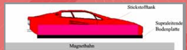
Die Spielzeugautos mit integriertem Kühltank und supraleitender Bodenplatte
