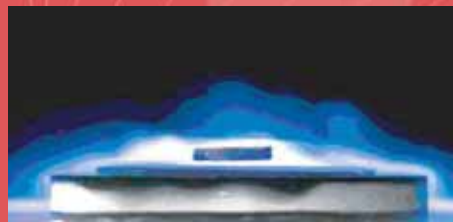
In einem geschlossenen supra-leitenden Ring fließt der induzierte Strom. Dieser erzeugt wiederum ein Magnetfeld, das den kleinen zylinderförmigen Magneten zum Schweben bringt.
